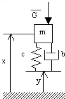
Рис.1. Упруго-инерционная модель механизма разводки моста
