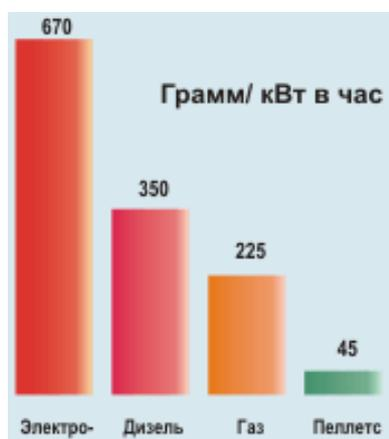
Рис. 1. Сравнительный график выброса  $\text{CO}_2$  (г/кВтч) в атмосферу для разных отопительных систем; цифры даны с учетом выброса  $\text{CO}_2$ , необходимого для получения данного топлива.
