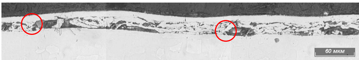
Рис. 1. Панорамное изображение дефекта “пленя” 232105-08Ю, ×500
