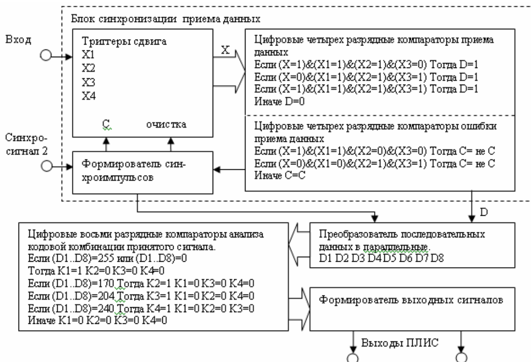
Рис. 4. Структурная схема ПЛИС демультиплексора
