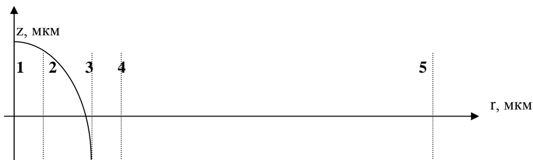
Рис. 1. Сечение эллипсоида плоскостью; пунктирные линии соответствуют направлению осей на которых рассчитывалась E(z) . 1) r=0 мкм, 2) r=0,06 мкм, 3) r = 0,12 мкм, 4) r=0,18 мкм, 5) r=0,4 мкм
