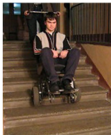
Рис. 2. Транспортировка студента-пользователя на ходовом макете мобильного лестничного подъемника "Вектор" с телескопическим гидродемпфером
