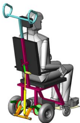
Рис. 1. Общий вид мобильного лестничного подъемника "Вектор" с телескопическим гидродемпфером
