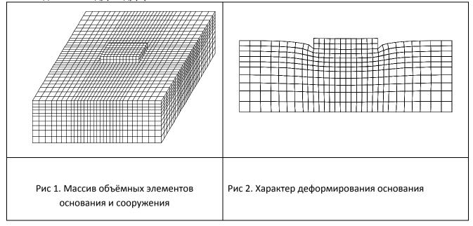
Таким образом, реализуя модель ЛДС с применением объёмных конечных элементов, возможно определить НДС не только отдельно взятого основания, но и системы сооружение-основание. При этом также можно найти осадки поверхности основания и за пределами площади загружения, что очень важно при оценке влияния друг на друга сооружений, расположенных, например, в стеснённой городской застройке.
