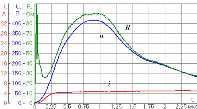
Рис. 1. Графики зависимостей  $u(t)$ ,  $i(t)$ ,  $R(t)$
