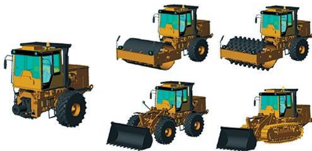
Рис. 2. Машины на базе колесного модуля, разработанные в SolidWorks
