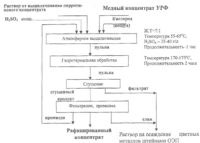
Рисунок 7. Принципиальная технологическая схема рафинирования медного концентрата УРФ
