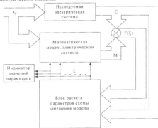
Рис. 1. Структурная схема идентификации
