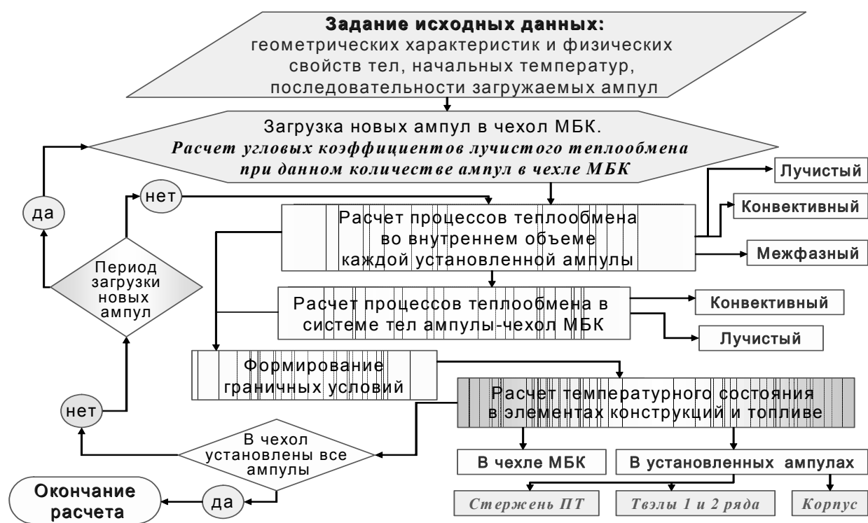
Рис. 2. – Блок-схема алгоритма численного моделирования загрузки ампул с ОЯТ РБМК-1000 в чехол МБК
