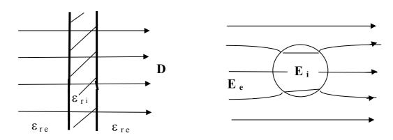
Цилиндр помещен в однородное поле  $\vec{E}_0$ . Внутреннее поле  $\vec{E}_i$  – однородно, а вне цилиндра появится дополнительное поле $\vec{E}'$ , такое, что полное поле  $\vec{E}_e = \overline{E}_0 + \vec{E}'$
