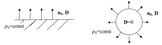
Из соотношения  $\vec{D} \, \vec{n}_0 = \rho_s$  можно найти поле на поверхности проводящего шара в изотропной среде, если известен его полный заряд q:  $\vec{D} = \vec{r}_0 q / (4 \pi \text{ R}^2)$ .
