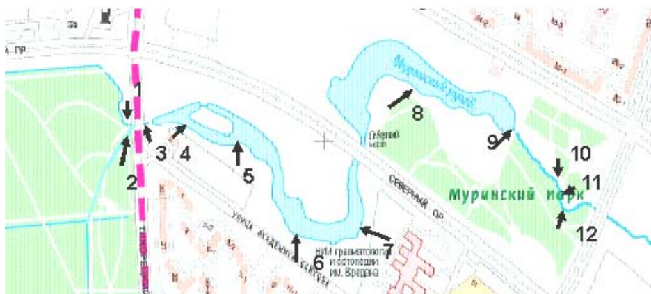
Рис.5. Схема отбора проб на участке Муринского ручья. Выпуски городской канализации находятся в точке 4 и между точками 10 и 11.
