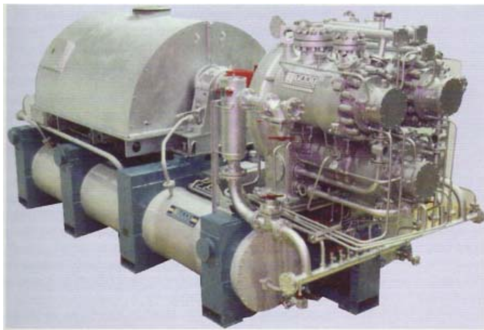
Рис. 3.1.13. Установка с трехвальным многоступенчатым центробежным компрессором для газлифта нефти (НИИТК – ККЗ).
