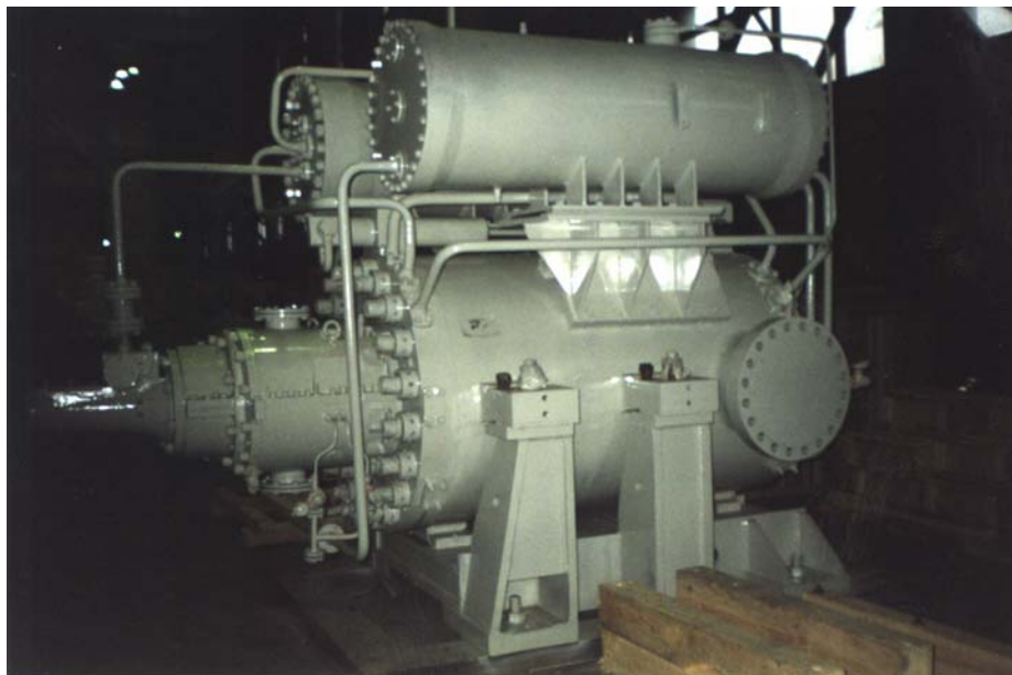
Рис. 1.3.15. Нагнетатель типа 108 для подземных хранилищ газа с конечным давлением 12,3 МПа. Сменные проточные части с 5 – 8 ступенями (ОАО «Компрессорный комплекс» по г/д проекту кафедры KBХТ СПбГПУ).
