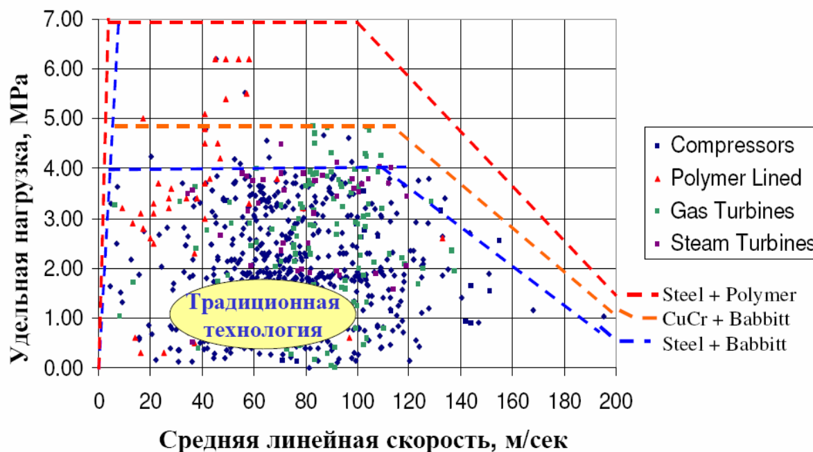
Рис. 4.6.6. Достигнутые параметры гидродинамических подшипников скольжения в зависимости от материала колодок и антифрикционного покрытия (Waukesha Bearings, США). Нижняя линия: сталь – баббит, средняя линия: сплав меди и хрома – баббит, верхняя линия: сталь – полимер.
