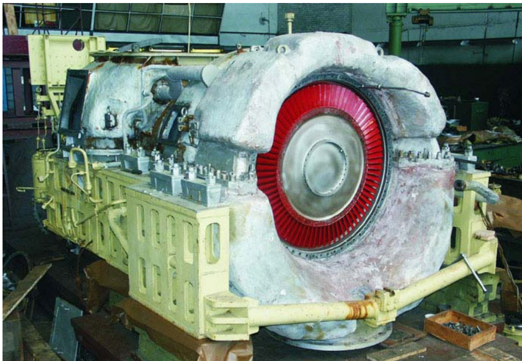
Рис.1.3.6. Агрегат наддува судового парогенератора с осевым компрессором ОАО «Киров – Энергомаш» (так же для антиобледенительных систем ледоколов, и пр.).
