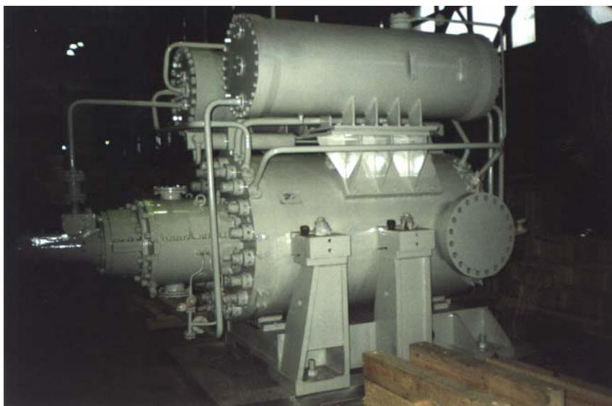
Рис. 1.3.15. Нагнетатель типа 108 для подземных хранилищ газа с конечным давлением 12,3 МПа. Сменные проточные части с 5 – 8 ступенями (ОАО «Компрессорный комплекс» по г/д проекту кафедры КВХТ СПбГПУ)
