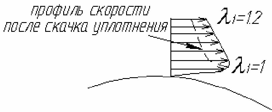
Рис.21.3. Профили скорости перед и после скачка уплотнения
