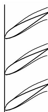
Рис. 3.6. Схема развития пограничных слоев на лопатках элементарной прямой решетки
