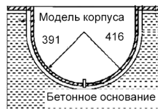
Рис. 3.: Схема и основные размеры модели корпуса
