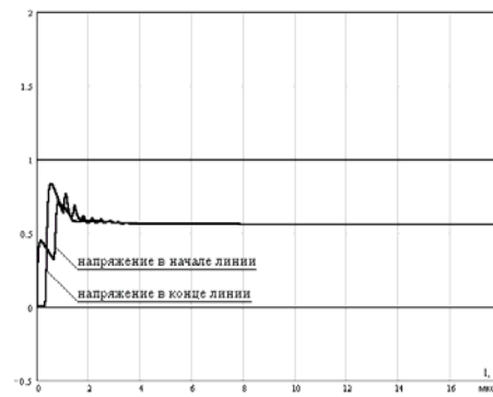
Рис. 12. Напряжения в функции времени при установке защитного устройства длиной 10 м и суммарным сопротивлением внешнего проводника 500 Ом.
