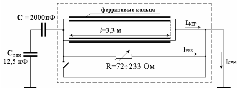
Рис. 16. Схема испытательного стенда. U_{\text{гин}} = 112 \text{ кВ} .
