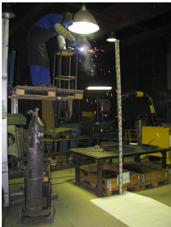
Рис. 6. Измерение гравитационной гидравлической крупности w частиц пыли, выделяющихся при сварочном производстве
