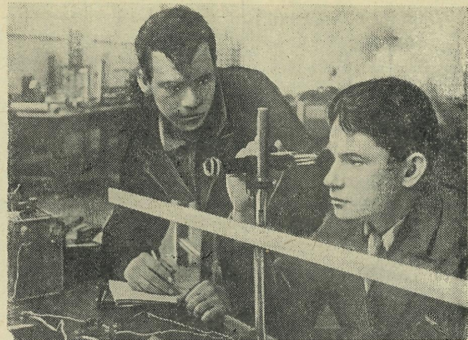
В лаборатории физики. Студенты В. Зайцев и В. Шаров выполняют работу на тему „сравнение емкостей посредством баллистического гальванометра“
