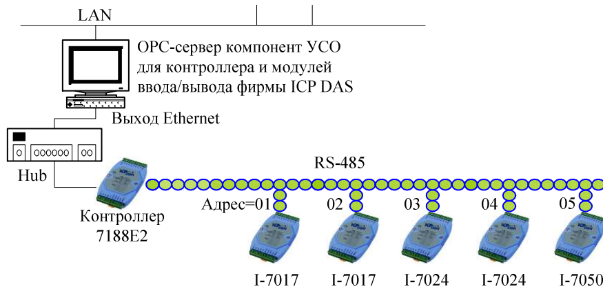
Рис. 5.1. Физическая структура системы мониторинга и управления модулями ввода-вывода промышленного контроллера типа 7188E2 фирмы ICP DAS
