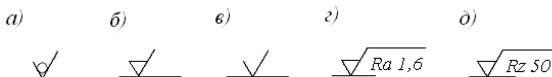
Рис. В.3. Обозначение шероховатости поверхностей, полученных:
