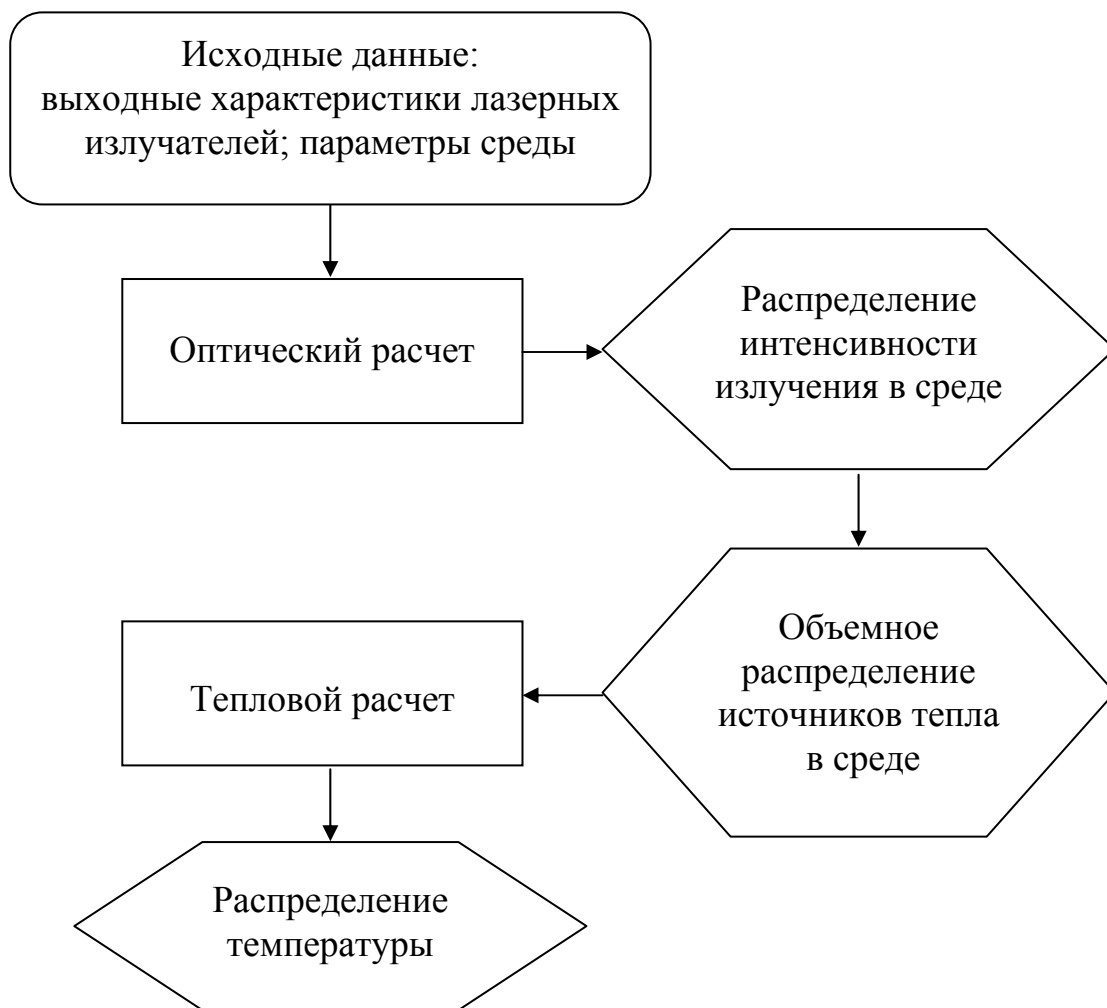
Рис. 2.8. Схема построения моделей, описывающих взаимодействие лазерного излучения с объектами
