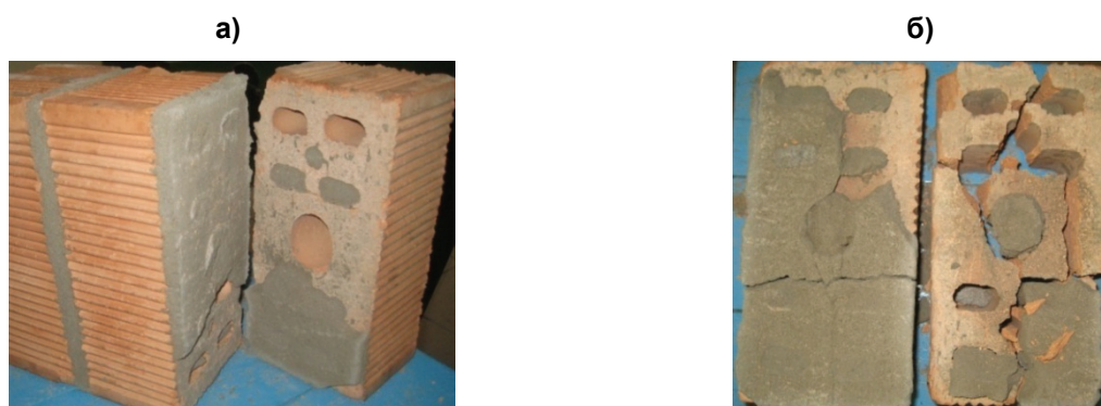
Рисунок 4. Характер разрушения образцов из пустотелого кирпича V=18%: а) потеря сцепления между камнем и раствором; б) разрыв камня и раствора
