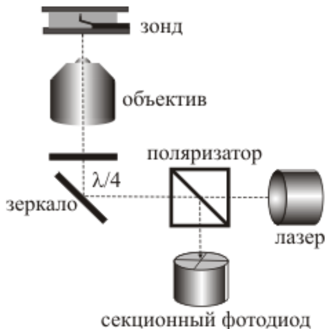
Рис. 66. Схема системы регистрации отклонения зонда высокоскоростного АСМ
