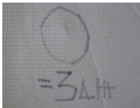
б) Ударная прочность = 3 Дж. Вмятина в месте удара
