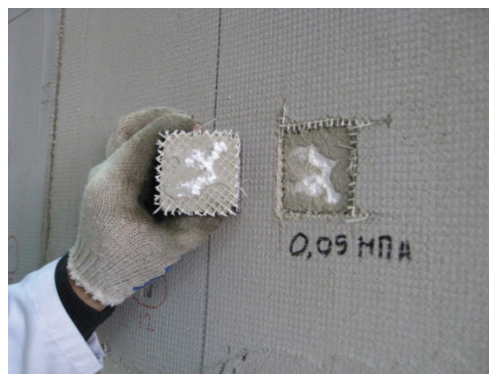
б) Адгезионная прочность 0,09 МПа. Отрыв по границе
