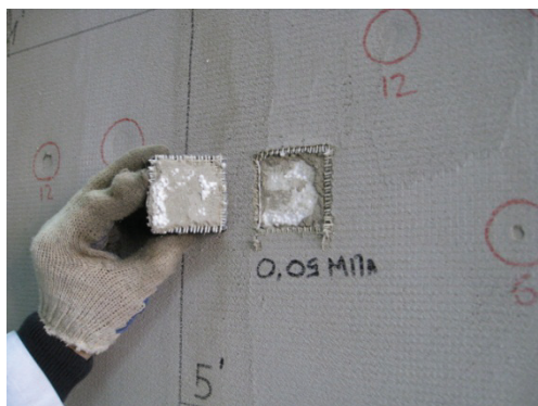
а) Адгезионная прочность 0,09 МПа. Отрыв по границе
