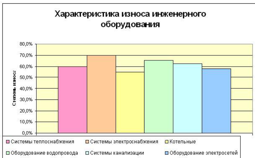
Рисунок 1. Характеристика технического состояния инженерных систем коммунального хозяйства
