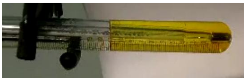
Рис.3 Образование бис-диметилгидразонаглиоксаля (пожелтение раствора) при добавлении уксусной кислоты
