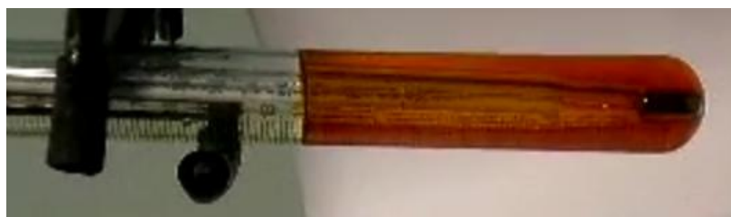
Рис.4 Образование красно-коричневых полимеров на начальной стадии
