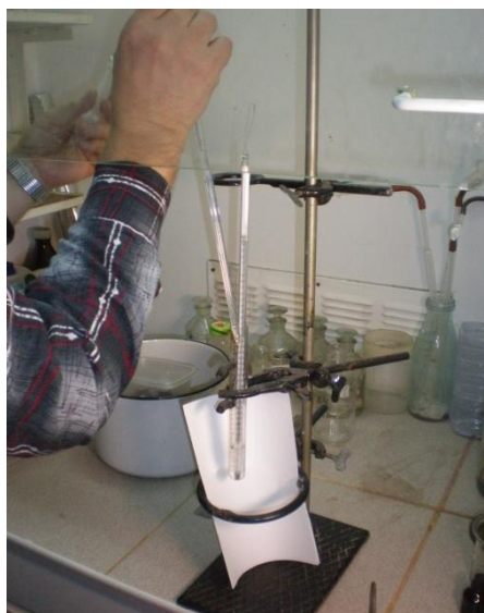
Рис.1 Процесс проведения нейтрализации НДМГ в пробирке. Смесь 2мл НДМГ с водой объемом 4 мл. Контроль температуры термометром комплекта ТЛ-6
