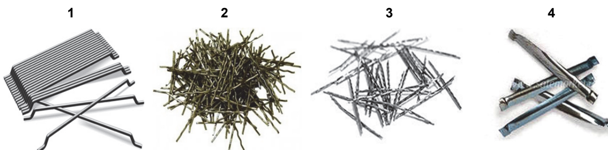
Рисунок 5. Виды стальной фибры: 1 – фибра проволочная анкерная 50×0,8мм; 2 – фибра волновая 30×0,8мм; 3 – фибра резаная из металлического листа 40×0,8мм; 4 – фибра фрезерованная из сляба 32×3,8 мм
