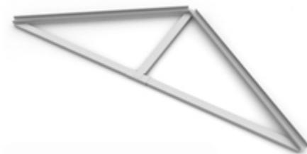
Рис. П.8.8. Раскладка профилей внутренней стропильной фермы
