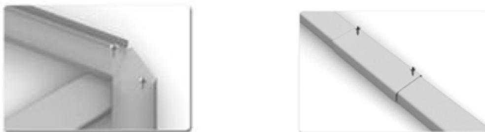
Рис. П.8.9. Предварительное крепление конькового узла и стропил
