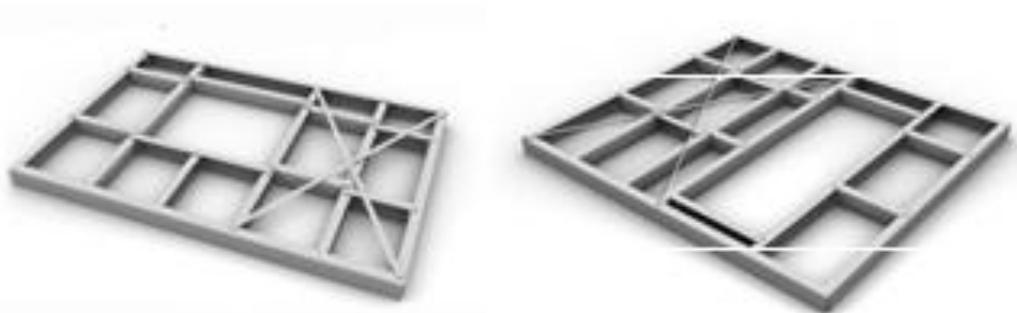
Рис. П.8.3. Сборка каркаса панели с проемами
