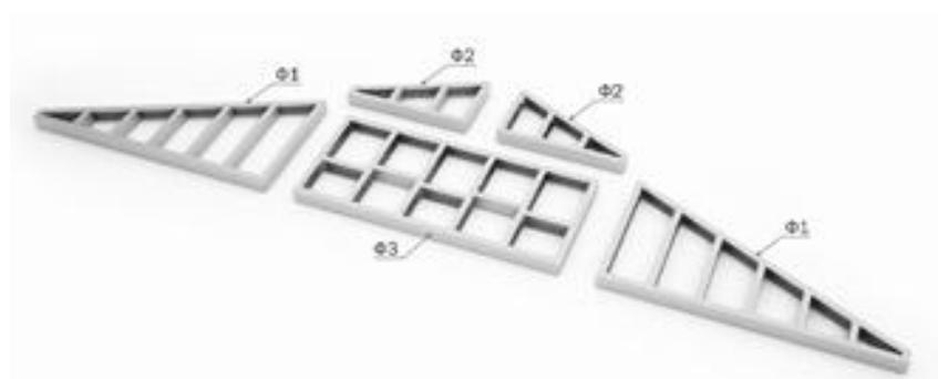
Рис. П.8.12. Сборка фронтовой фермы из узловых ферм
