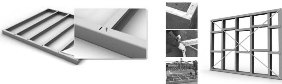
Рис. П.8.2. Сборка и раскрепление каркаса панели
