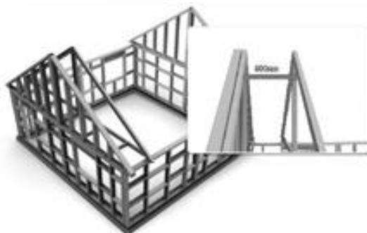
Рис. П.8.24. Монтаж внутренних стропильных секций
