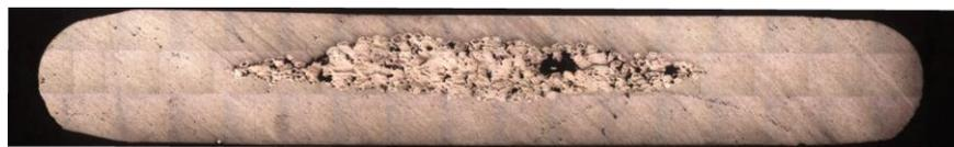
Рис. 16. Макроструктура образца после горячей прокатки без РКУП
