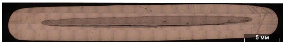
Рис. 15. Макроструктура образца после РКУП и горячей прокатки
