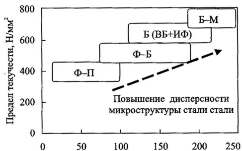
Рис. 3.4. Тенденция развития микроструктуры трубных сталей (Ф - феррит; ВБ - верхний бейнит; ИФ - игольчатый феррит; Б - бейнит; М - мартенсит) [59]
