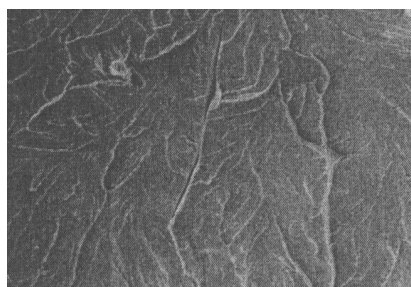
Рис. 2.6. Характерный хрупкий излом. Эвтектоидная углеродистая сталь в охрупченном состоянии после отжига
