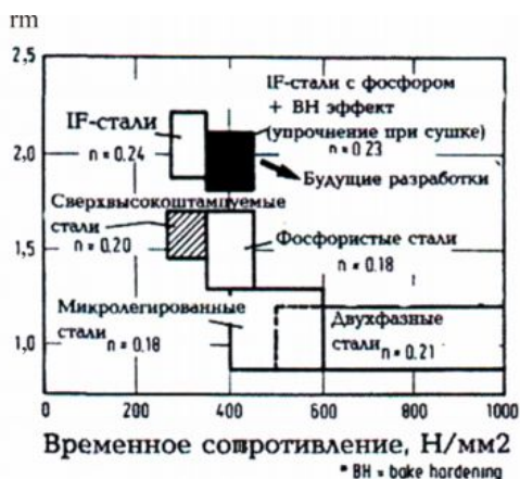
Рис. 3.6. Прочность и штампуемость листа из различных типов сталей
