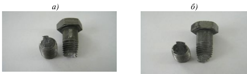
Рис. 6.9. Общий вид болтов после испытаний: а – из УМЗ стали марки 20 (класс прочности 6.8 \sigma_{\text{в}} = 686 \text{ Н/мм}^2 ); б – из УМЗ стали марки 45 (класс прочности 8.8, \sigma_{\text{в}} = 873 \text{ Н/мм}^2 )
