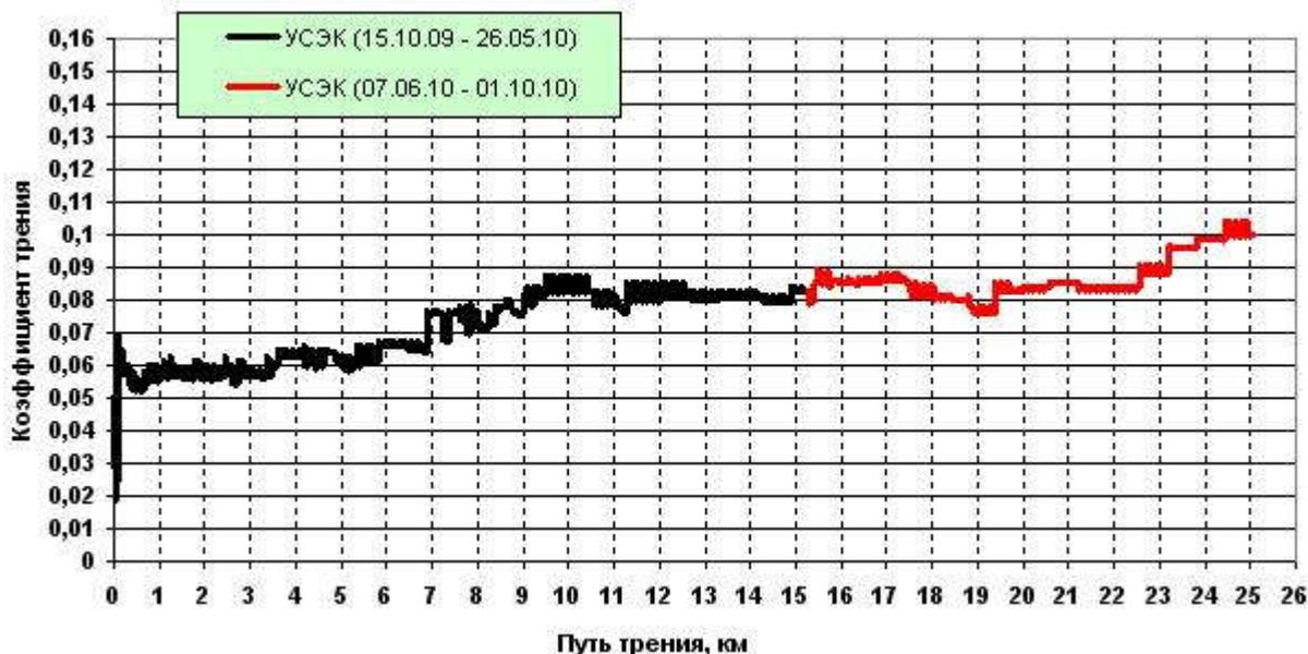
Рисунок 5 Ресурсные испытания материала марки УСЭК.
