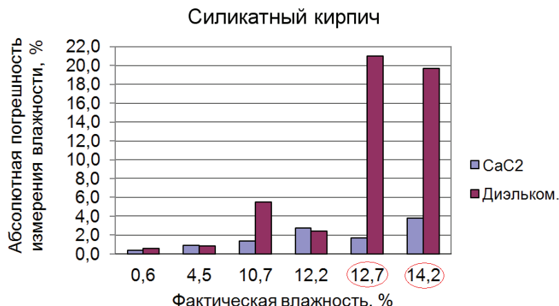
Рисунок 12. Погрешность определения влажности силикатного кирпича (красным выделены засоленные образцы)
