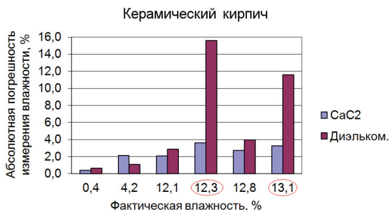
Рисунок 11. Погрешность определения влажности керамического кирпича (красным выделены засоленные образцы)
