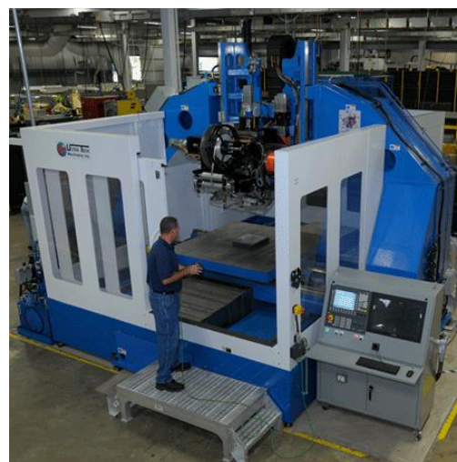
Рис. 59. Форма для литья под давлением. Машина SonicLayer 7200 . Источник – Wohlers Report 2012
