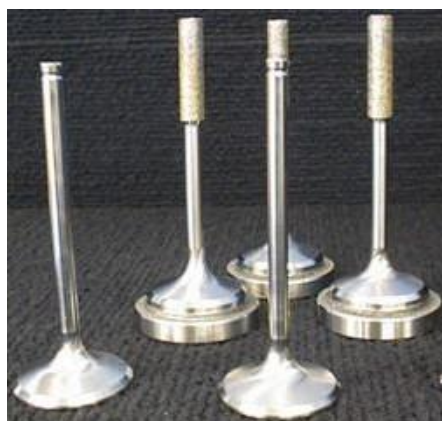
Рис. 25. Выпускные клапаны из титанового сплава (технология LENS )
