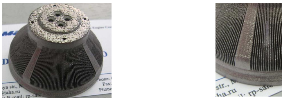
Рис. 36. Деталь электротехнического устройства, построенная на машине SLM 280 . Толщина рёбер - 0,35 мм. Предоставлено ФГУП «НАМИ»
