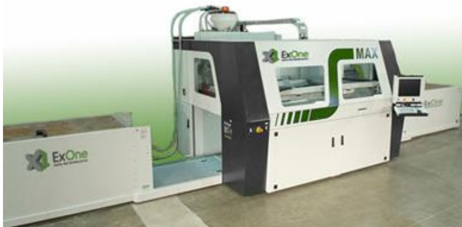
Рис. 28. Машина S-Max для выращивания песчаных форм
