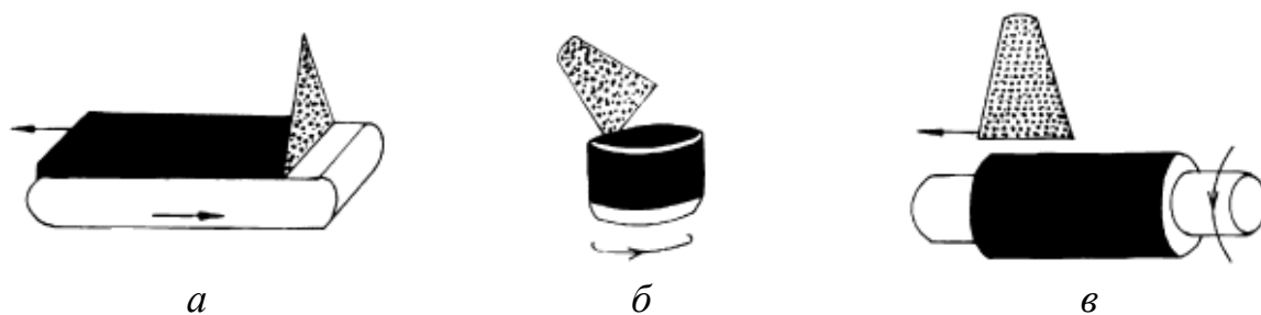
Рис. 120. Получение заготовок разных типов (технология spray forming )
