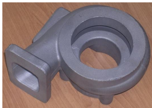
Рис. 92. Оболочковая форма и чугунная отливка корпуса турбины, полученные по восковой синтез-модели. Предоставлено ФГУП «НАМИ»
