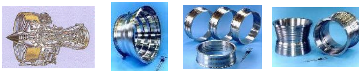
Рис. 126. Детали авиадвигателя, полученные по технологии « Spray forming »
