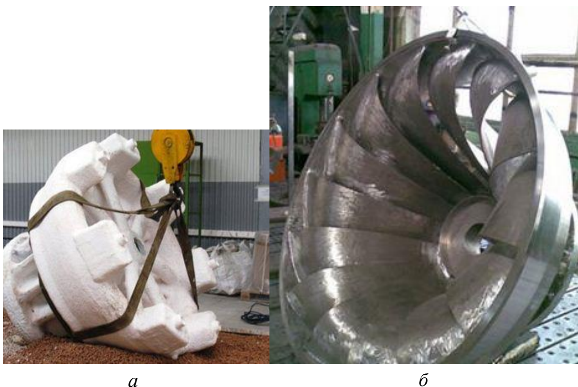
Рис. 84. Рабочее колесо турбины: а – оболочковая форма, б – отливка. Предоставлено ОАО «ТМЗ»
