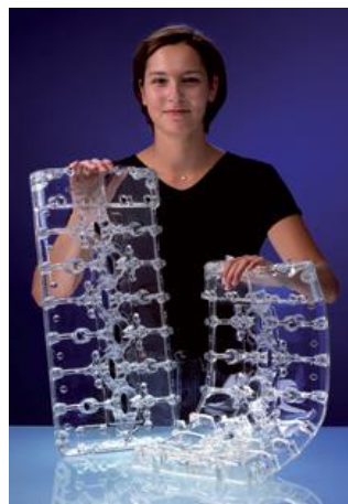
Рис. 101. Отливки из полиуретана, полученные литьем в силиконовые формы. Предоставлено SLM Solutios
