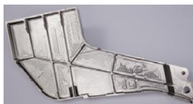
Рис. 55. Изготовление детали по технологии Sciaky
