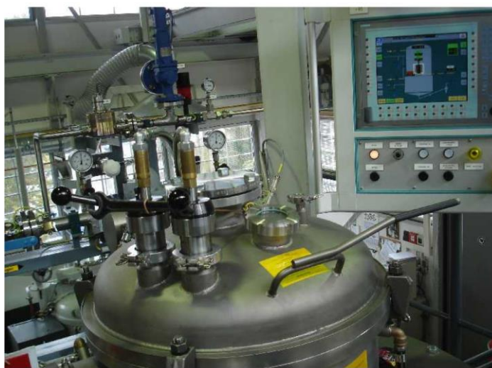
Рис. 136. Плавильная камера атомайзера VIGA 2
