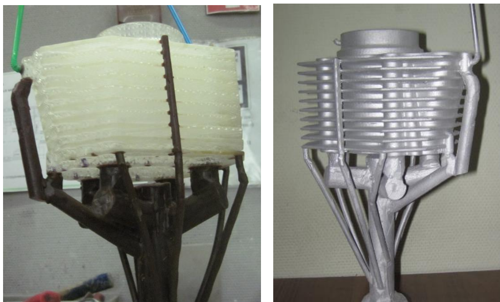
Рис. 80. Quick-cast модель с литниковой системой и алюминиевая отливка цилиндра. Предоставлено ФГУП «НАМИ»
