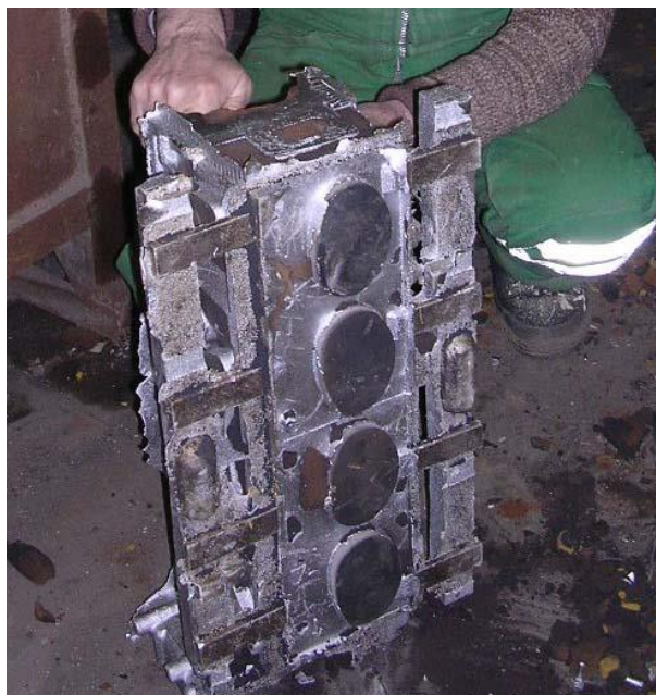
Рис. 95. Алюминиевая отливка головки цилиндров, изготовленная по SLS-технологии . Предоставлено ФГУП «НАМИ»
