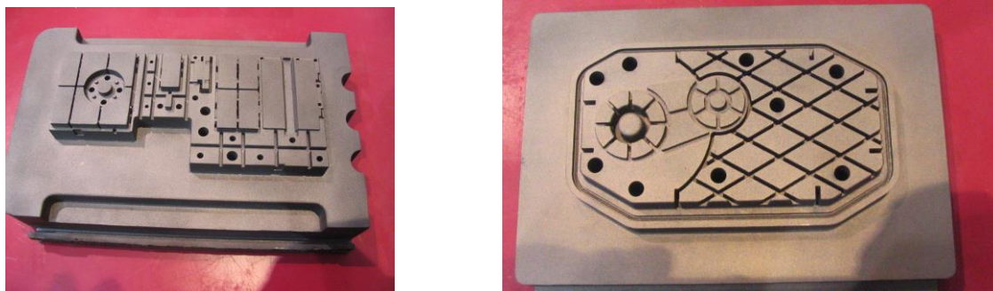
Рис. 104. Синтезированные металлические вставки для литья деталей из пластмассы. Предоставлено 3D Systems
