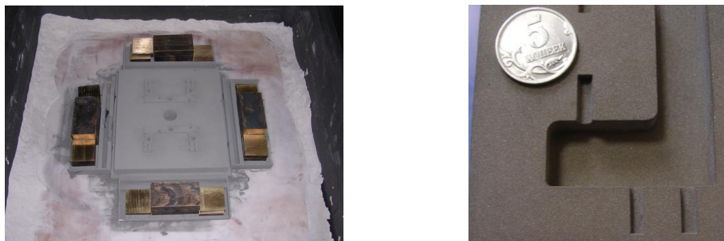
Рис. 41. Грин-модель вставки ТПА, технология 3D Systems . Предоставлено ФГУП «НАМИ»
