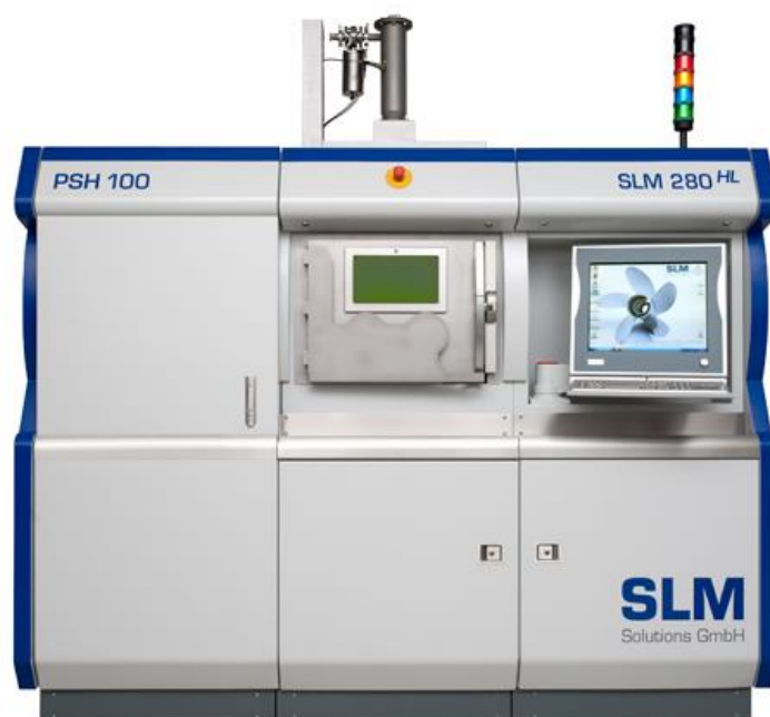
Рис. 22. Машина SLM 280 с двумя лазерами ( SLM Solution )
