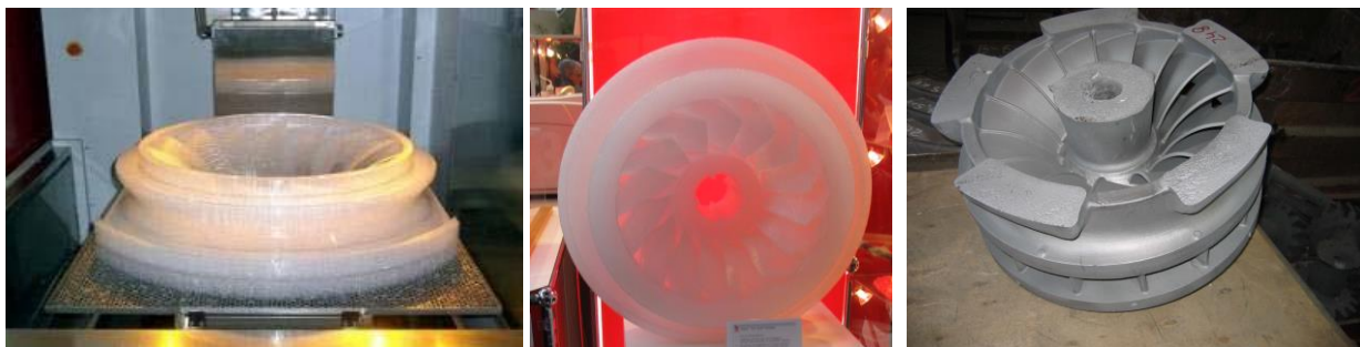
Рис. 21. SLA-модель и отливка рабочего колеса турбоагрегата. Предоставлено ОАО «Тушинский машиностроительный завод»
