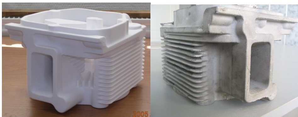
Рис. 67. Полистирольная модель и отливка головки цилиндра ДВС.
