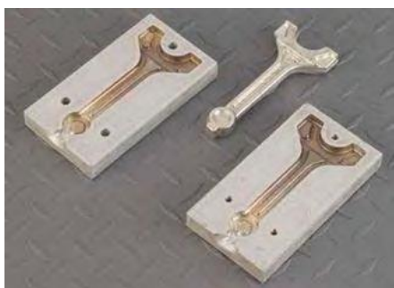
Рис. 59. Форма для литья под давлением. Машина SonicLayer 7200 . Источник – Wohlers Report 2012
