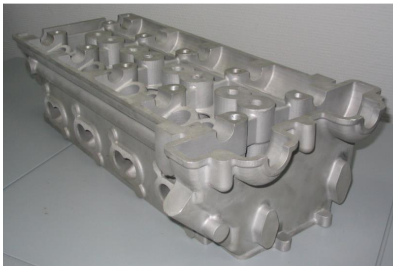
Рис. 79. Алюминиевая отливка головки цилиндров. Предоставлено ФГУП «НАМИ»
