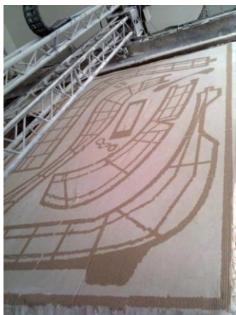
Рис. 4. Принтер итальянского инженера Enrico Dini для «печати» фрагментов зданий (технология Inkjet). Строительный материал – песок и неорганическое связующее
