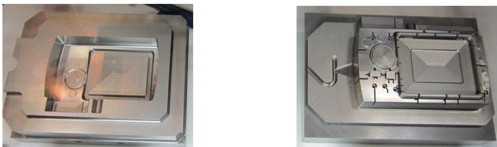
Рис. 44. Пресс-форма для литья корпуса цифровой фотокамеры [7]
