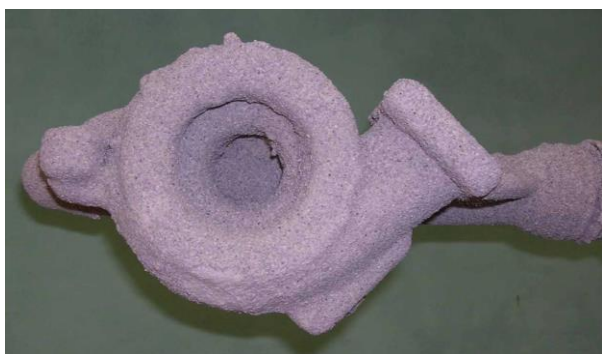
Рис. 92. Оболочковая форма и чугунная отливка корпуса турбины, полученные по восковой синтез-модели. Предоставлено ФГУП «НАМИ»
