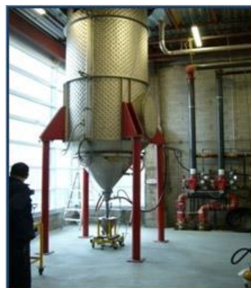
Рис. 109. Технология Plasma Atomization : а – схема процесса плазменной атомизации; б – атомайзер Raymor [18]
