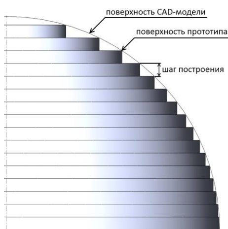
Рис. 61. Послойный принцип построения модели
