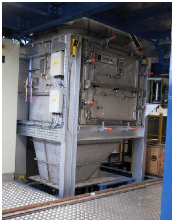
Рис. 127. Установка « Spray forming », емкость до 80 кг по Al. Оксфордский университет
