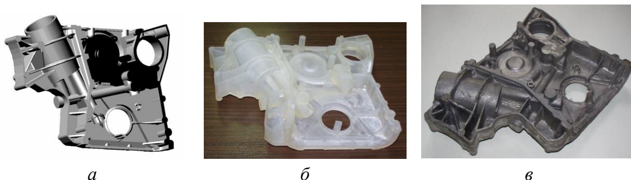
Рис. 83. Передняя крышка ДВС: а – CAD-модель, б – SLA-модель, в – отливка «в землю». Предоставлено ФГУП «НАМИ»
