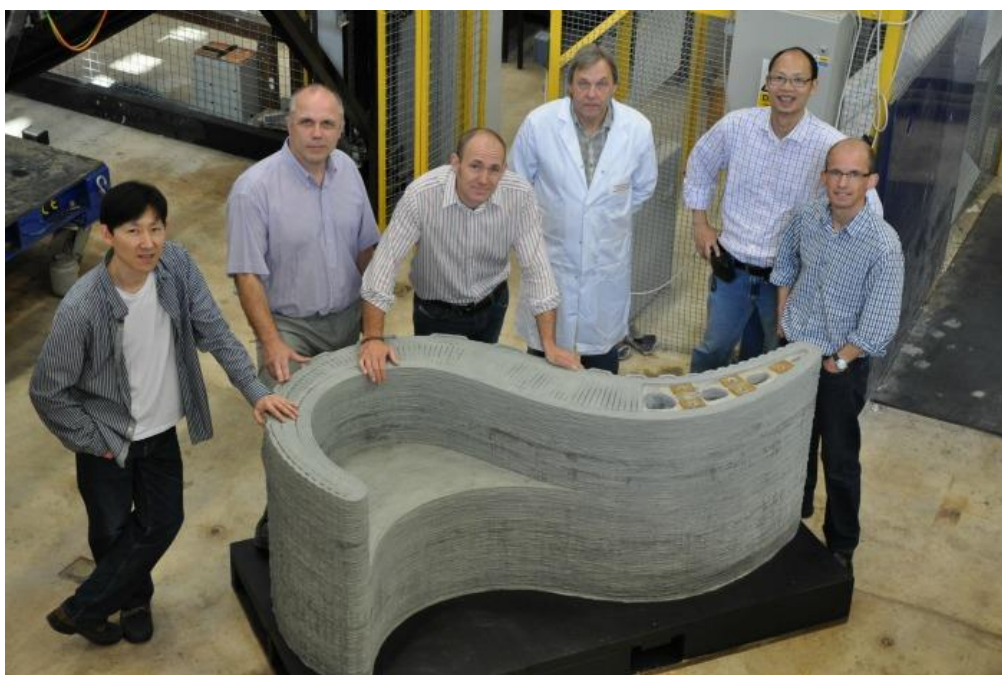
Рис. 5. Разработка принтера экструзионного типа для применения в строительстве (Loughborough University, Великобритания)
