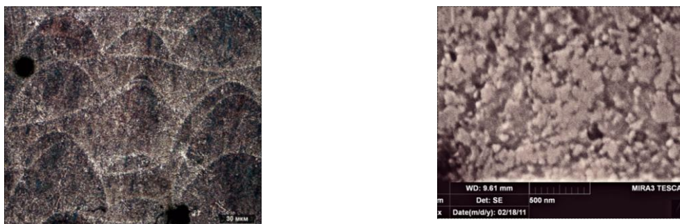
Рис. 45. Микроструктура сплава AlSi9Mg [52]. Предоставлено СПбГПУ
