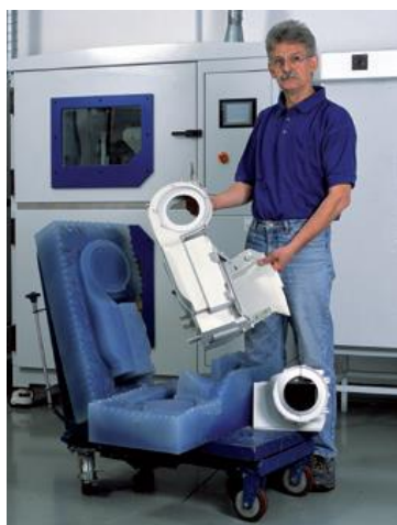
Рис. 101. Отливки из полиуретана, полученные литьем в силиконовые формы. Предоставлено SLM Solutios
