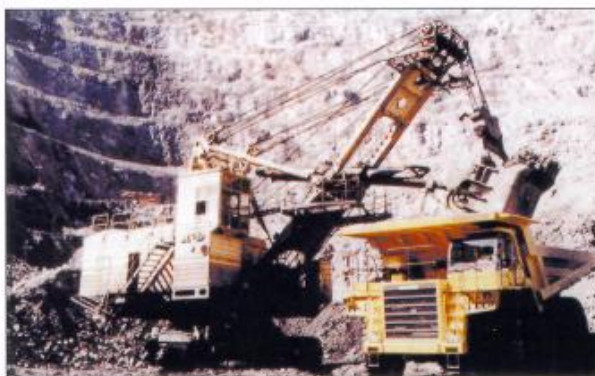
Карьерный автосамосвал HD-785-5 на погрузке в Соколовском карьере
