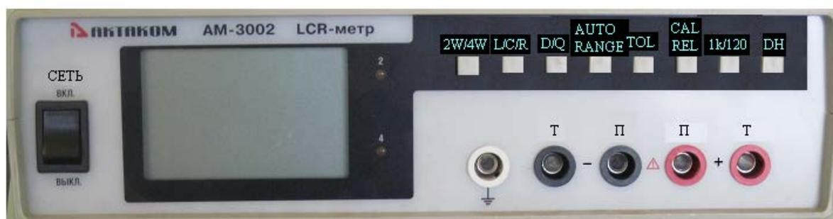
Рис. 4.1. Передняя панель цифрового LCR - метра.
