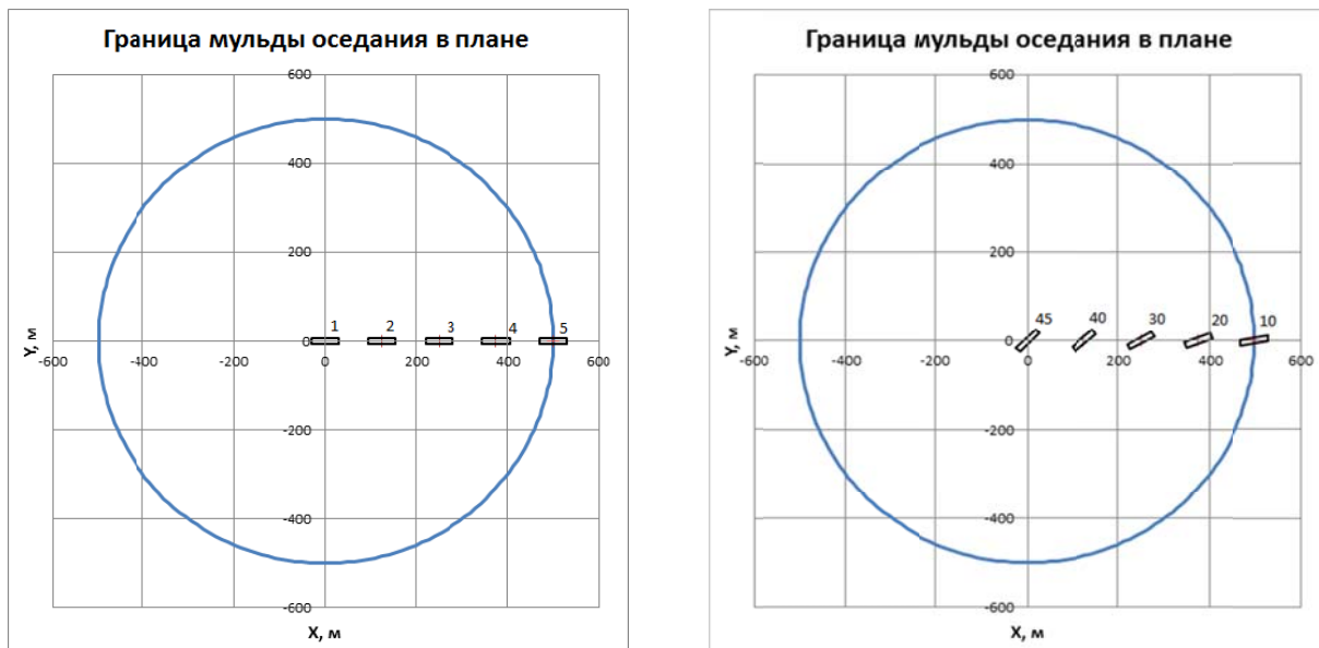
Рисунок 11. Положения здания в мульдe оседания
