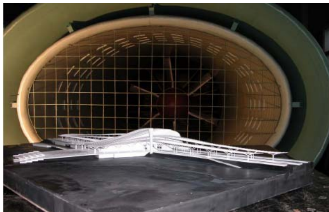
Рисунок 1. Макет здания вокзала в аэродинамической трубе
