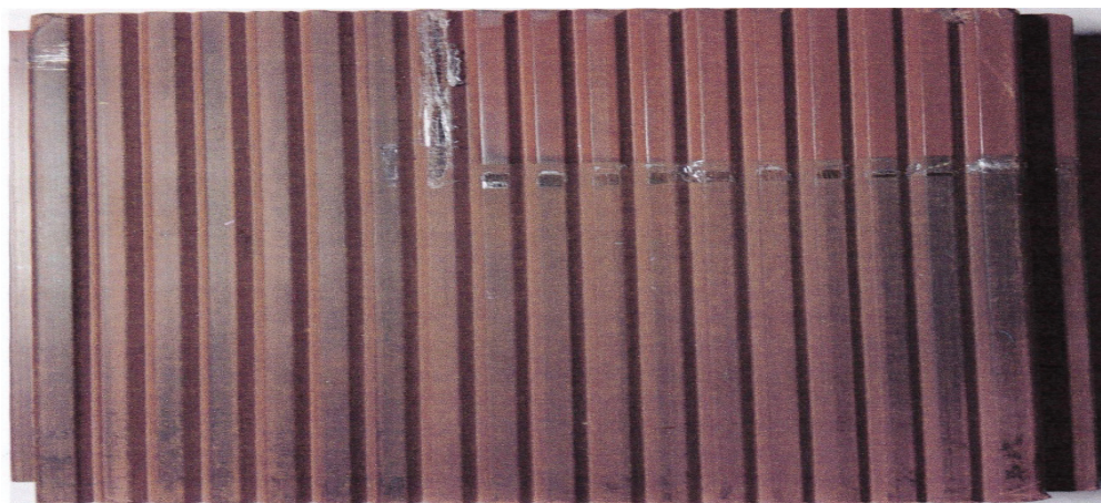
Рисунок 4. Изменение внешнего вида террасной доски ПМК
