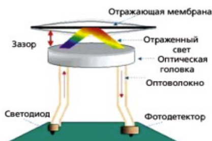
Рисунок. Принцип работы оптического микрофона
