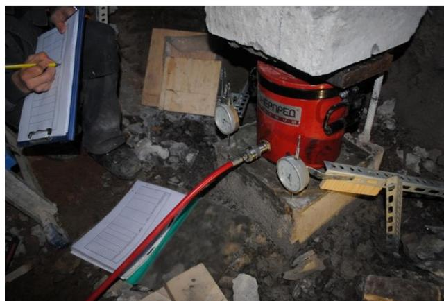
**Рисунок 6. Испытательное оборудование на свае в шурфе №21**
