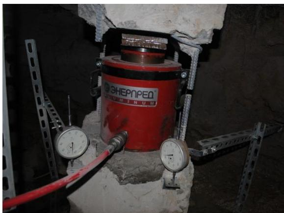
**Рисунок 5. Испытательное оборудование на свае в шурфе №20**
