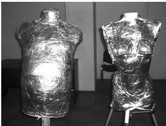
Рис. 3. Используемые макеты человеческих тел, обернутые в фольгу для создания рассеивающих свойств ( а ), и их микроволновые изображения (позиции объектов — те же самые) ( б ). Размеры параллелепипеда — 2 \times 1 \times 3 м
