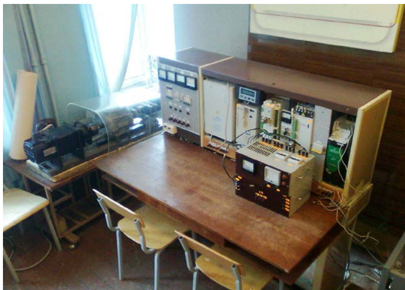
Рис. 1. Специализированный стенд для научных исследований электрической части КГУМ
