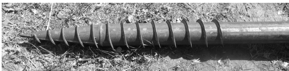
Рис. 6. Испытанная статическими сжимающими нагрузками винтовая узколопастная металлическая свая
