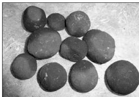
Рис. 2. Гранулы состава «угольный отсев : связующее» — 70:30 с введением угольного шлама
