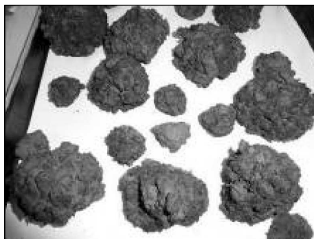
Рис. 1. Гранулы состава «угольный отсев : связующее» — 50:50
