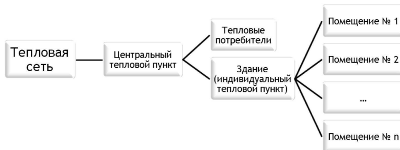
Рис. 2. Структура тепловой модели системы теплоснабжения здания
