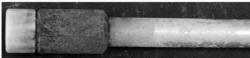
Рис. 12. Внешний вид стержневого образца сплава 1953Т1 с оксидным покрытием зоны контакта (резьба) и открытой поверхности длиной 15 мм от места контакта со сталью 40ХН2МА после испытаний для определения скорости коррозии в 5 %-м растворе NaCl при температуре 80 °С
