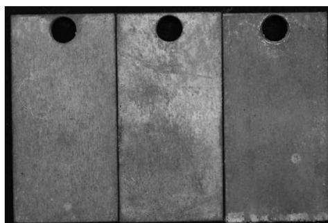
Рис. 8. Внешний вид образцов сплава 1953Т1 после испытаний для определения скорости коррозии в 5 %-м растворе NaCl при температуре 80 °С в отсутствие контакта со сталью
