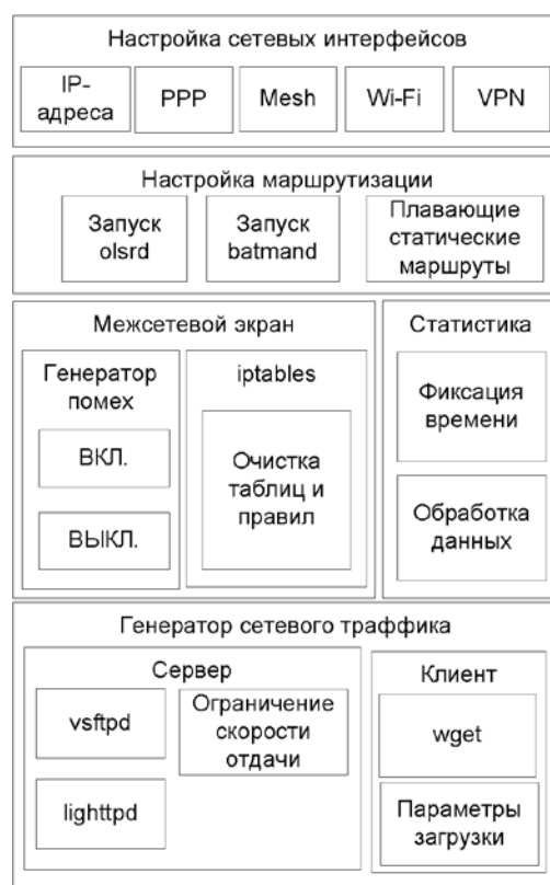
Рис. 2. Архитектура программного обеспечения стенда
