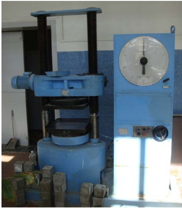
Рис.10. Электрический пресс с максимальным усилием до 125 т в лаборатории неразрушающего контроля ОАО ПСК «Строитель Астрахани»
