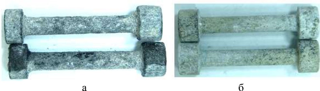
Рис. 11. Внешний вид образцов сплава Д16Т (а) и 1953Т1 (б) после технологического нагрева (200 °С, 6 мин) и последующей эксплуатационной выдержки (150 °С, 500 ч) в растворе NaCl + NaOH (рН = 11)
